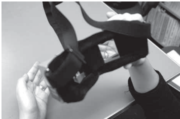
左右反転めがねのプリズムを通してみると、指輪をしている左手が右手のように見える。
