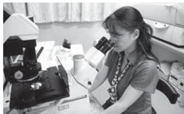
共焦点レーザー顕微鏡を用いて観察中
